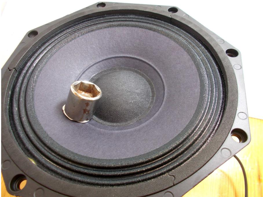
Enfin, cliquez sur "Measure V(as)" afin d'obtenir les paramètres manquants V(as) et M(ms). Ces derniers s'affichent dans la partie "Measured Parameters". Il est possible que le logiciel ne puisse pas effectuer le calcul si la masse utilisée est trop légère par rapport à celle de la membrane. Dans ce cas, utilisez une masse plus importante et répétez la procédure.
