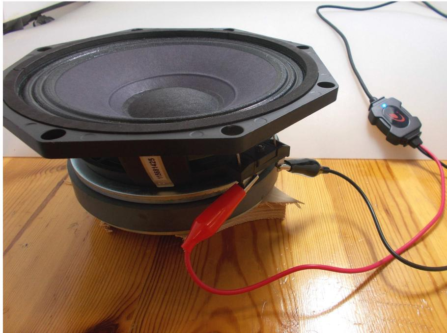
Lancez à présent la mesure en pressant le bouton "Measure Free Air Parameters" sur la gauche de l'interface logicielle. Vous pouvez entendre le signal type sinus glissant émis par le haut-parleur. La courbe d'impédance et la courbe de phase associée s'affichent alors.
