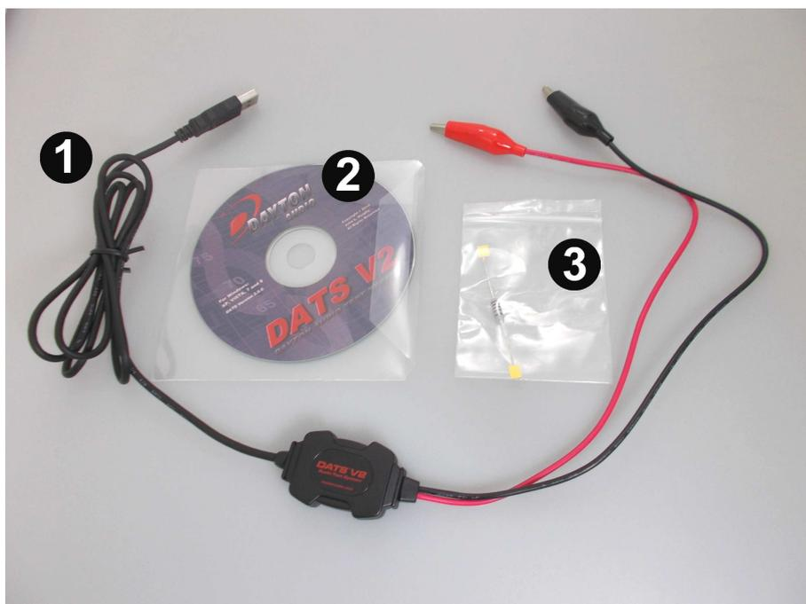
Avant même de brancher l'interface USB, commencez par installer le logiciel. Pour cela, insérez le CD-ROM d'installation dans votre ordinateur (systèmes d'exploitation supportés: Windows XP, 7, 8 et Vista), rendez vous dans l'explorateur et faites un clic droit sur le lecteur disque renommé "DATS V2", puis choisissez "Explorer". Double-cliquez ensuite sur l'exécutable "DATS V2\_setup.exe" pour lancer l'installation.
