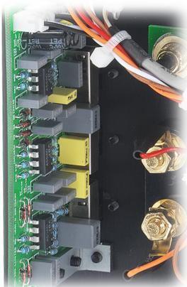
La technologie X-gard™ contourne les inconvénients d'un classique filtre subsonique en assurant que l'excursion du haut-parleur ne dépasse jamais une limite absolue (risque de casse, distorsion très élevée) quel que soit l'amplitude du signal d'entrée. Cette technologie préserve le signal et sa phase (contrairement à un filtre subsonique). L'extrême grave est plus fidèle, le raccord avec les enceintes principales plus homogène et le haut-parleur protégé.
