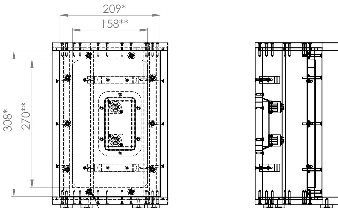
Les 10 vis / écrous de fixation de la façade avant peuvent être recouverts par le saladier du haut-parleur utilisé en prenant soin de ne pas avoir les vis de fixation du haut-parleur qui "tombent" dans les vis de fixation de la façade
