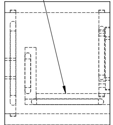
Quatre perçages en façade arrière pour installer deux paires de bornes Atohm WT-FB-1160-G pour bi-amplification
